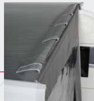
Schuimstofstrook en magneten voor een goede afsluiting met het luifeldak
