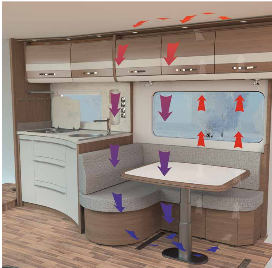
» AirPlus ventileert de bovenkasten en voorkomt zo de vorming van condenswater
